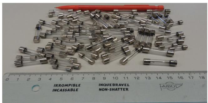
Fig. 5. Quantidade de fusíveis, para multímetro, queimados ao final de um semestre, provenientes de um único laboratório tradicional.
