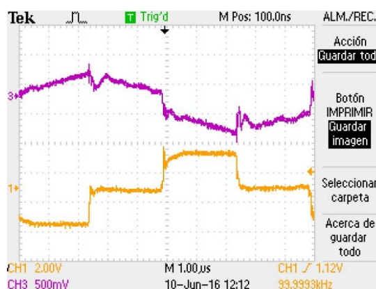
Figura 7 Formas de onda experimentales (full bridge): corriente por la inductancia del primario invertida (morado) y tensión en el secundario (amarillo)
