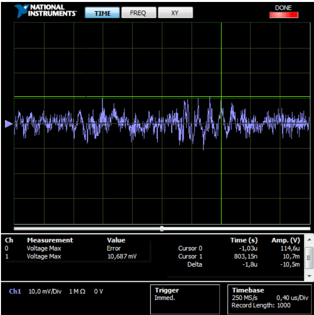
Fig. 16. Fonte CC em 6 V – Acoplamento CA – Pico: 10,7 mV.
