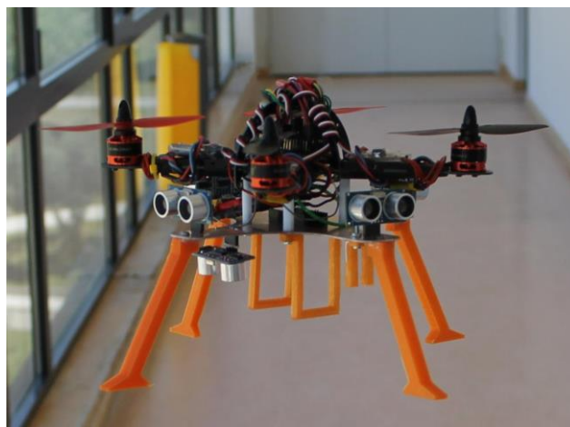
Figura .12. Cuadricóptero tamaño 250 con sistema de detección y evasión de colisiones y mantenimiento automático de altura basado en ultrasonidos.
