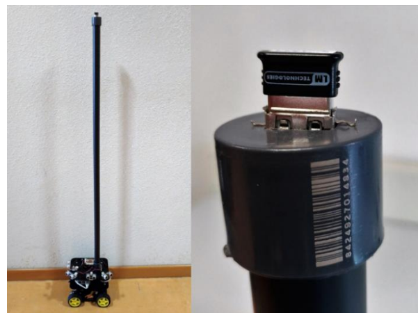
Figura .9. Variante con tarjeta microcontroladora Romeo y detalle de la parte superior del módulo para medida de intensidad de señal de Bluetooth.
