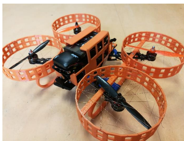
Figura .13. Cuadricóptero tamaño 330 con sistema de protección fabricado por impresión 3D.
