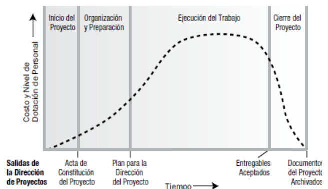
Fig. 1 Niveles típicos de costo y dotación personal en una estructura genérica de ciclo de vida del proyecto (tomado del PMBOK).
