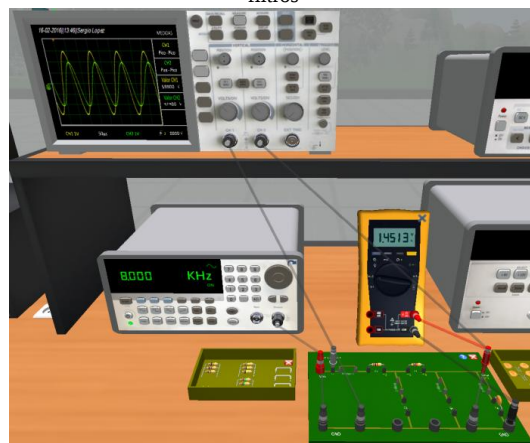
Fig. 11. Montaje y prueba de un filtro paso bajo con eLab3D
