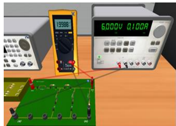
Fig. 4. Montaje y prueba del circuito con resistores con eLab3D
