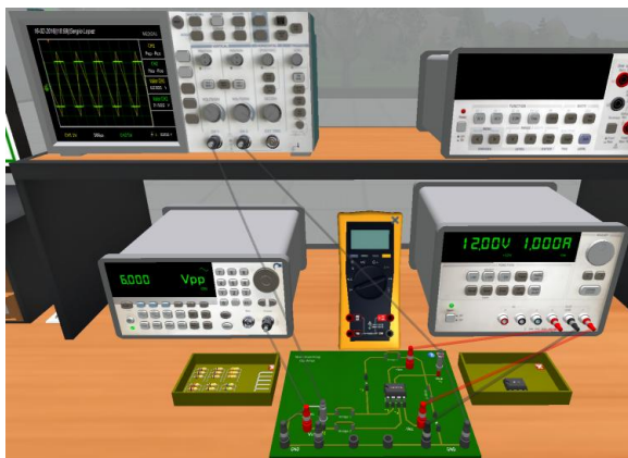
Fig. 8. Montaje y prueba de un circuito comparador con eLab3D
