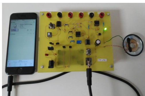
Fig. 7. Experimento para amplificar señales de audio
