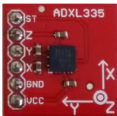
Fig. 3. Detalle del acelerómetro ADXL335.
