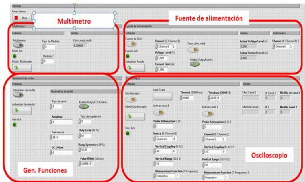
Fig. 8 Apariencia de los instrumentos virtuales desarrollados en labVIEW para el control de los instrumentos del laboratorio.
