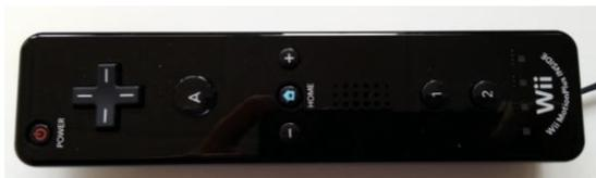
Fig. 8. Wiimote. El acelerómetro está localizado debajo del botón “A”.
