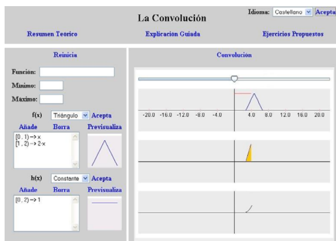
Fig. 2. Aspecto de la simulación de la convolución
